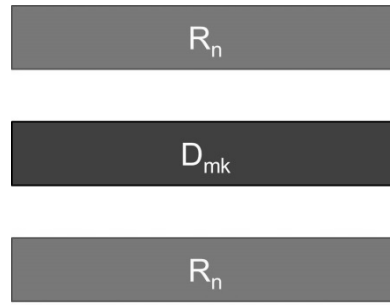
Hình 7. Mô hình vật liệu có cấu trúc bánh kẹp dựa trên nano graphene R_n/D_{mk}/R_n .
