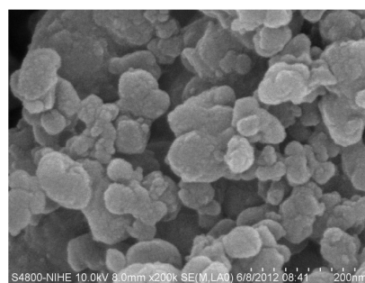
Hình 3.3. Hình ảnh SEM của mẫu Mg-HAp với tỉ lệ [Mg^{2+}]/[Ca^{2+}] = 2/8
